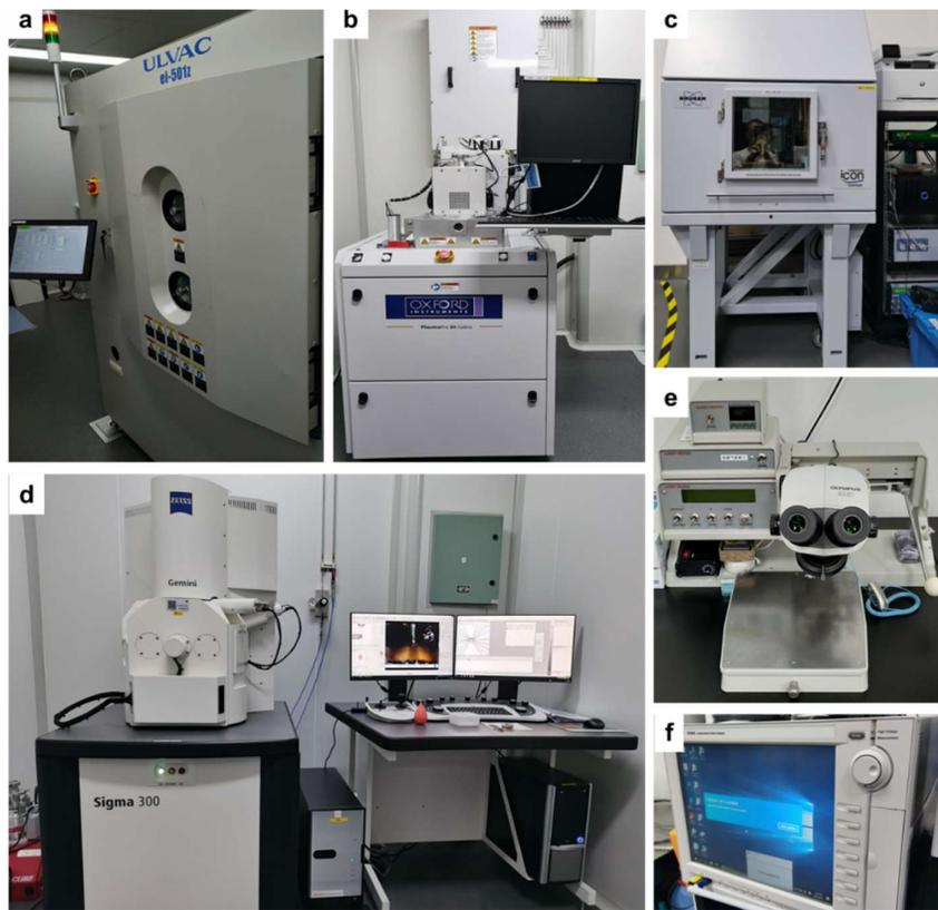
图3. a) 电子束蒸发镀膜仪； b) 反应离子刻蚀仪； c) 搭载于原子力显微镜的nanoMan扫描探针系统； d) 电子束曝光； e) 金丝楔焊机； f) 半导体分析测试仪器
