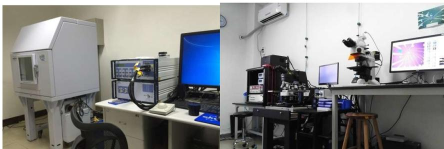
图 1.原子力显微镜系统、二维材料转印堆垛平台和纳米器件制备设备
