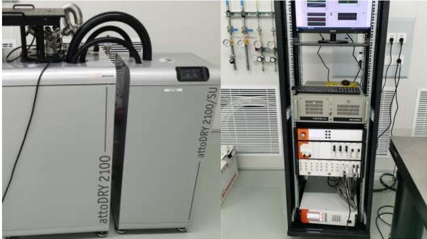
图7. 基态温度1.5 K 磁光电联合测试系统
