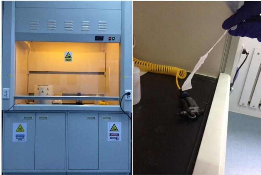
图 8. 左：通风橱的外观。右：正确风量的检测
